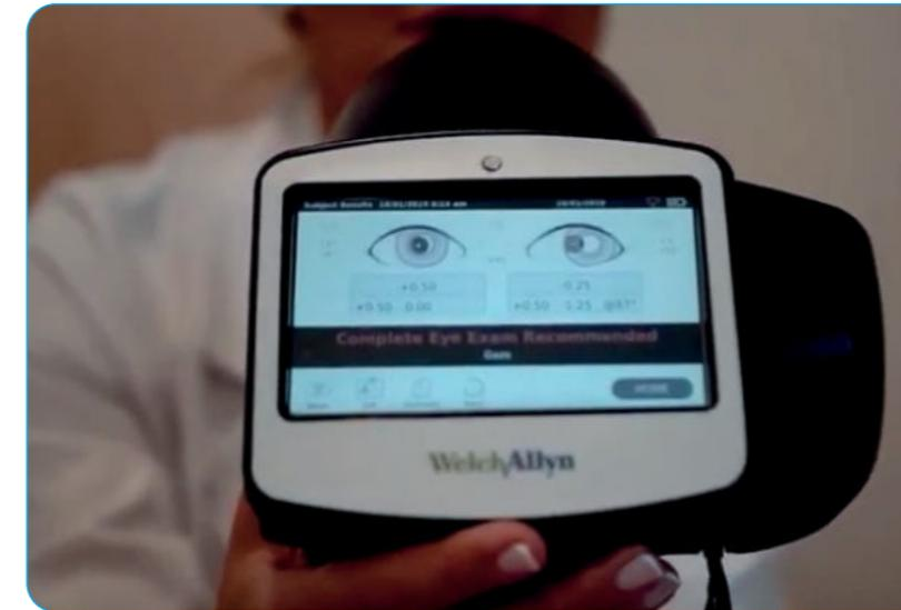
С помощью данного прибора у нас есть возможность определить точную рефракцию и угол косоглазия у малышей
